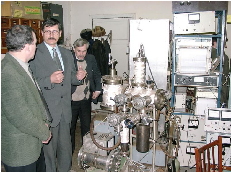
Вакуумно-водородная установка для изучения индуцированных водородом фазовых превращений в интерметаллидах. Обсуждается тема докторской (доцент Н.Н. Власенко, в центре) и кандидатской (ассистент А.Г. Васильев, справа) диссертаций.
