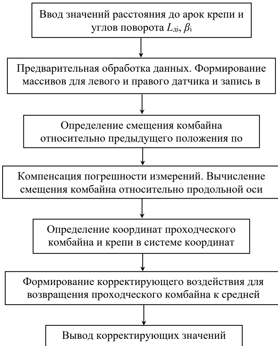
Рисунок 4.10 – Структурная схема алгоритма реализации метода определения местоположения проходческого комбайна по данным дальномеров
