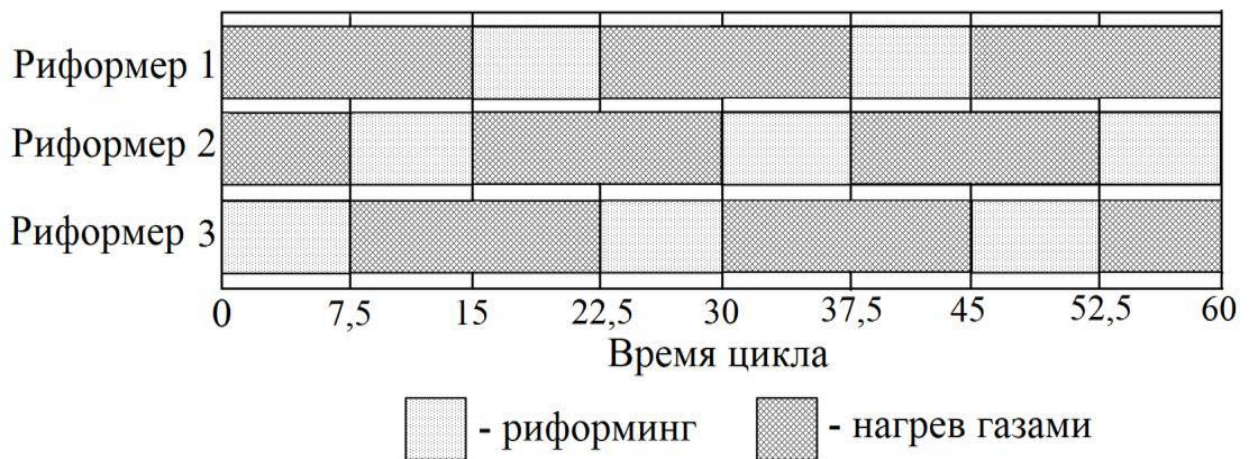
Рисунок 4.25 – Схема работы трех реакторов по регенеративному принципу при начальной скорости реакционной смеси 4 м/с и греющего теплоносителя 10 м/с
