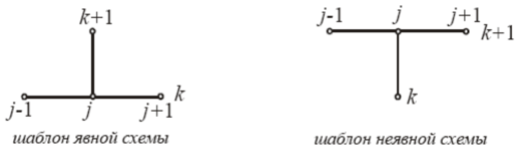
Рисунок 2.3 – Шаблоны явной и неявной конечно-разностных схем для решения дифференциального уравнения
