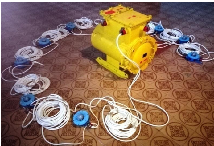
Рисунок 6— Комплекс устройств освещения шахтного КУОШ
